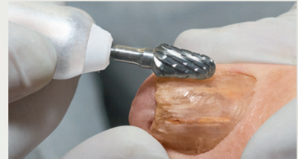
Hartmetallfräser H79SGE 104 070 mit SGE-Verzahnung zum Abtragen von stark verdickten Nägeln.
