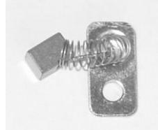
Setzen Sie eine neue Kohle ein. Prüfen Sie die Position der Feder auf der Kohle. Die Feder muß mittig auf der Kohle liegen. Die Kohle ist ein Verschleißteil und muß bei Abnutzung ausgetauscht werden. Ein Paar Ersatzkohlen liegen bei. Prüfen Sie anschließend auch die zweite Kohle.
